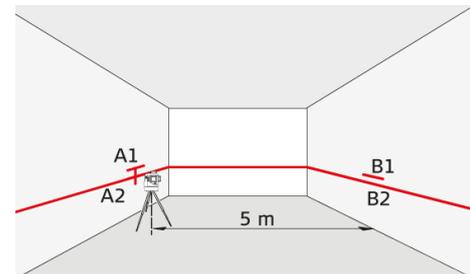
Затем поместите прибор на той же высоте как можно ближе к стене А и снова отметьте горизонтальную линию лазера или лазерную точку на стене А (A2). Разверните прибор на 180 градусов снова и сделайте отметку на стене В (B2). Измерьте расстояние между отмеченными точками A1-A2 и B1-B2. Подсчитайте разницу между двумя замерами.
