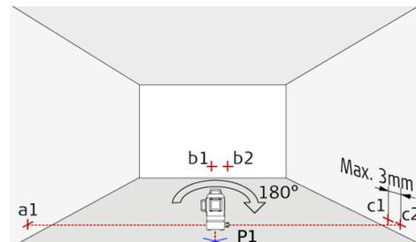
Затем поверните прибор на 180° вокруг точки пересечения отвеса P1 и установите правый перпендикулярный луч на имеющейся контрольной точке a1. Убедитесь, что нижняя точка пересечения отвеса все еще находится точно на контрольной точке P1. Затем отметьте левый луч на правой стене с помощью c2. Затем измерьте разницу между предыдущей контрольной точкой c1 и новой точкой c2. Разница между двумя точками не должна превышать 3 мм.
