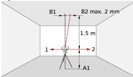
Установите блокировку в положение «Разблокировано» (см. [Блокировка выравнивания](#)). Установите лазер на его штатив или на кронштейн для настенного монтажа рядом с точкой A1 на минимальном расстоянии 1,5 м от точки B1. Горизонтальная линия лазера выровнена в направлении 1. Отметьте лазерные точки A1 и B1 маркером.
