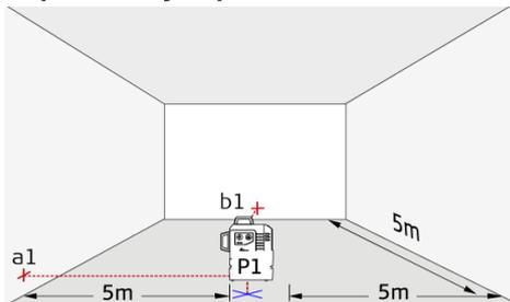
Установите блокировку в положение «Разблокировано» (см. [Блокировка выравнивания](#)). Отметьте контрольную точку (P1) на расстоянии прим. 5 м от стен и установите точно на ней нижнюю точку пересечения отвеса. Выровняйте окулярную сетку по левой стене и отметьте точку пересечения (a1) на высоте прим. равной расстоянию P1 до стены. Сразу после этого отметьте правый перпендикулярный луч (b1) на стене.
