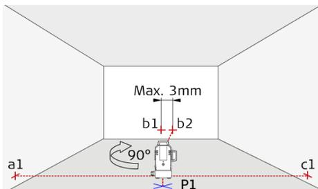
Затем поверните прибор на 90° по часовой стрелке вокруг точки пересечения отвеса P1 и установите левый перпендикулярный луч на имеющейся контрольной точке a1. Убедитесь, что нижняя точка пересечения отвеса все еще находится точно на контрольной точке P1. Затем сверьте новую контрольную точку b2 со старой контрольной точкой b1 на передней стене. Отклонение между двумя точками не должно превышать 3 мм. Отметьте новое положение правого перпендикулярного луча на правой стене с помощью c1.
