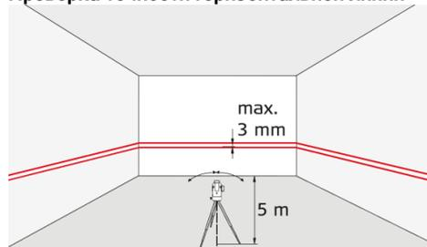
Установите блокировку в положение «Разблокировано» (см. [Блокировка выравнивания](#)). Установите прибор на расстоянии примерно 5 м от стены. Наведите прибор на стену и включите его. Включите линию лазера и отметьте точку пересечения лучей лазера на стене. Разверните прибор вправо, а затем влево. Зафиксируйте вертикальное отклонение горизонтальной линии от отметки. If the difference does not exceed 3 mm, then the instrument is within tolerance.
