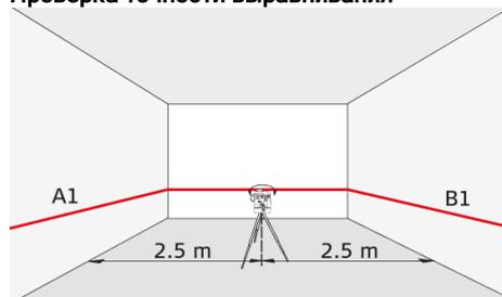
Установите прибор на штативе на равном расстоянии от двух стен (A+B), которые отстоят друг от друга примерно на 5 метров. Установите блокировку в положение «Разблокировано» (см. [Блокировка выравнивания](#)). Наведите прибор на стену А и включите его. Включите горизонтальную линию лазера или лазерную точку и отметьте положение линии или точки на стене (A1). Разверните прибор на 180 градусов и отметьте горизонтальную линию лазера или лазерную точку таким же образом на стене (B1).
