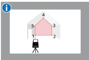
Площадь рассчитывается на основе нескольких известных координат с помощью значений x, y и z.
