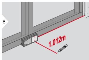
8 Медленно перемещайте прибор вдоль линии разметки. На дисплее отобразится расстояние до следующей точки разметки.
