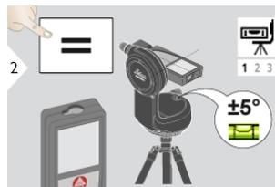
Для выполнения выравнивания диапазон наклона прибора должен составлять +/- 5°.
