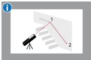
Промежуточное расстояние рассчитывается на основе двух известных координат с помощью значений  $x$ ,  $y$  и  $z$ .
