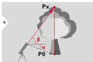
Направьте лазер на верхние точки и отслеживание угла/высоты начнется автоматически.
