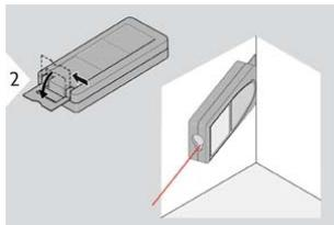
**i** Положение позиционной скобы определяется автоматически, и соответственно устанавливается начало отсчета.
