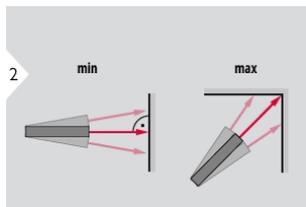
Эта функция используется для измерения диагоналей (максимальные значение) или горизонтальных расстояний до вертикальной поверхности (минимальное значение).
