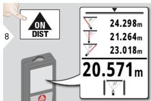
**i** Результат отображается в итоговой строке, и измеренное расстояние - выше. Нажатие на клавишу измерения в течение 2 сек. активирует автоматическое выполнение измерений минимального и максимального расстояния.
