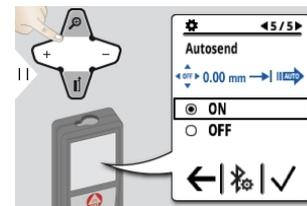
11 Выберите автоматическую или ручную передачу значения.
