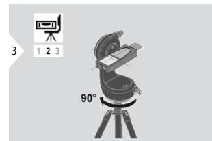
Поверните прибор по направлению движения часовой стрелки на 90°. Следуйте инструкциям на дисплее.
