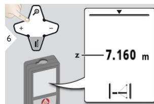
**i** Можно определить высоту здания или дерева без подходящих точек отражения. В нижней точке, измеряется расстояние и угол наклона - это требует отражающую лазерную мишень. Верхнюю точку можно отметить при помощи визира / окулярной сетки. Отражающая лазерная мишень не требуется, так как измеряется только угол наклона. Используйте навигационную кнопку Вниз, чтобы отобразить больше результатов
